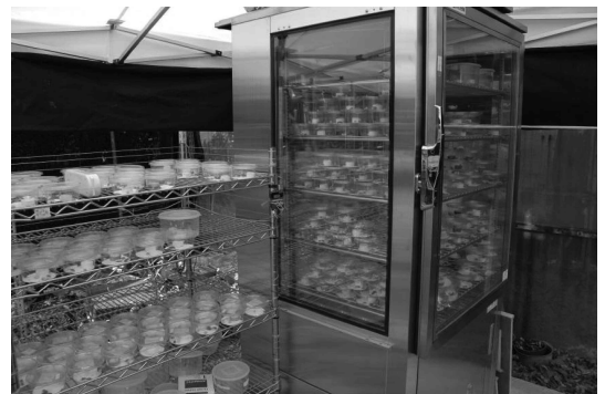
図-1 温暖化シミュレーション装置 (右側のインキュベータ)
