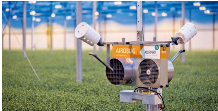
図-2 電動式天敵放飼装置「AIROBUG」
